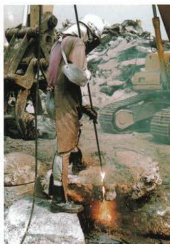
Cutting of stainless scrap ステンレススクラップ溶断
