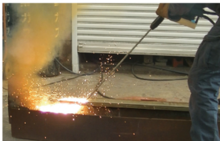
4. ステンレス板(25mm)の熔断
