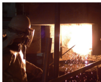
炉前出湯口の開削作業
