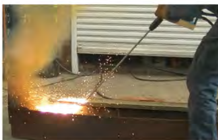
4. ステンレス板(25mm)の熔断
